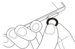
SIM取り出し用ピンや、ペーパークリップなどでカードトレイにある穴にピンの先を挿しこみ、トレイが飛び出すまでピンを押し込みます。
