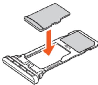
**3** UQ mobile Multi IC Card 01 / microSDメモリカードトレイを本体に対して水平に、奥までしっかり差し込む
